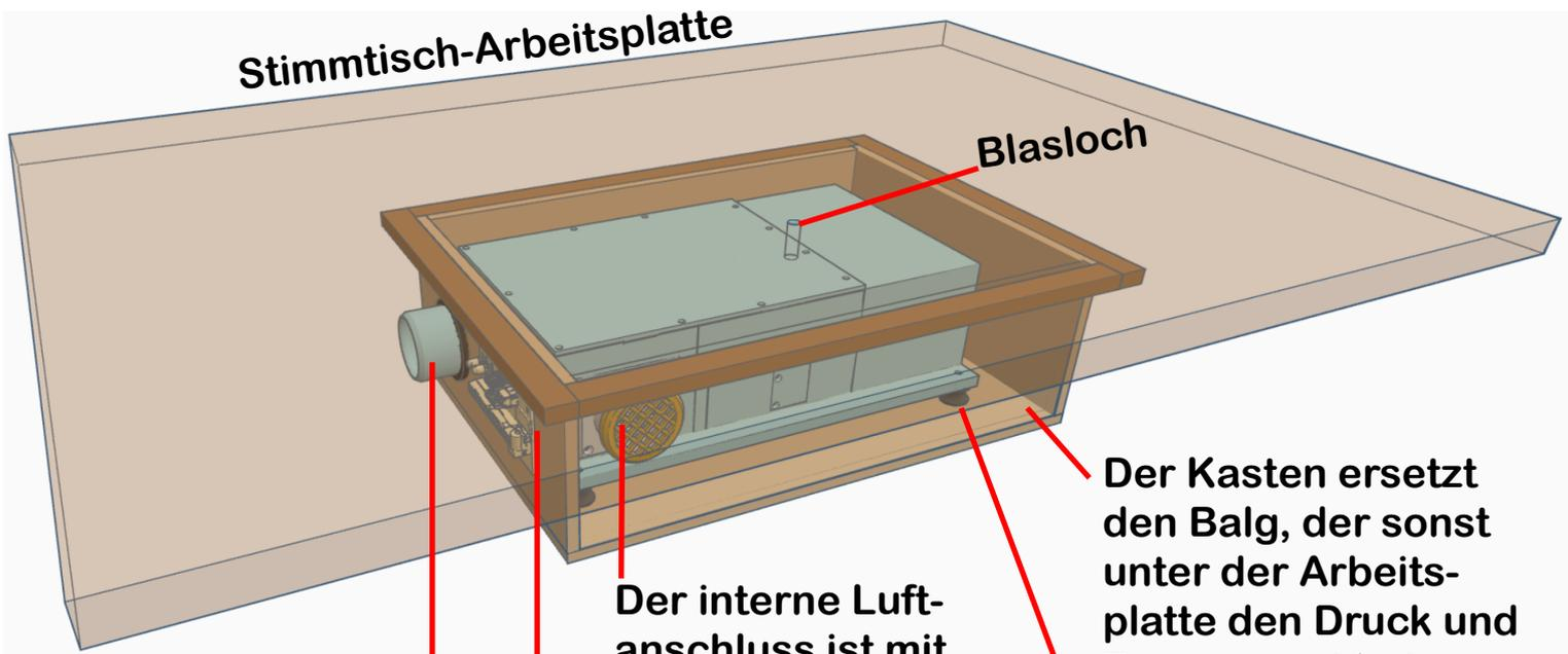
Der externe Luftanschluss geht mit einer Dichtung durch die Wand des Kastens. Ausströmende Luft erzeugt Unterdruck im Kasten, angesaugte Luft erzeugt Überdruck (Druck) im Kasten.
