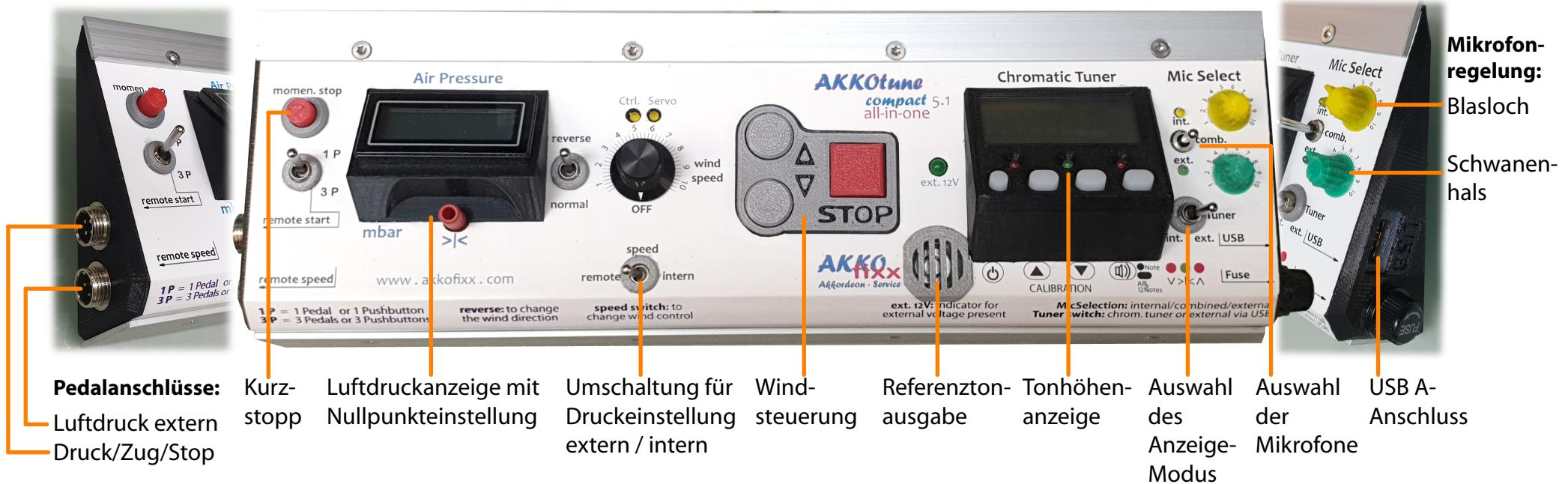
**Wie bisher:** Einstellung des Lufdrucks, Umschaltung der Windrichtung, Anzeige des Lufdrucks, Fernstart mit optionalem Fußschalter und Kurzstopp.
