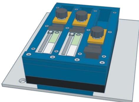
Flache Führungsschienen ermöglichen das Stimmen direkt im Halter.
